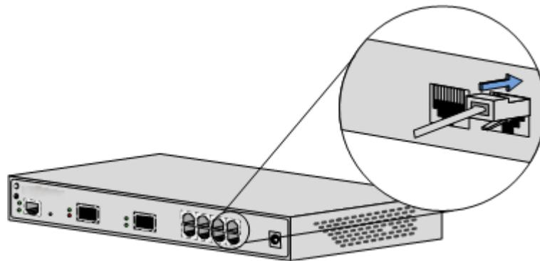
步骤 3 将以太网线缆的另一端 RJ45 连接器插入对端设备。
