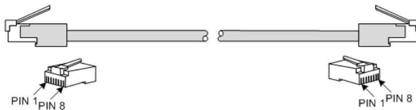
P500 设备的以太网接口支持直通网线模式和交叉网线模式的自适应，故连接以太网业务接口时，两种网线均适用。
