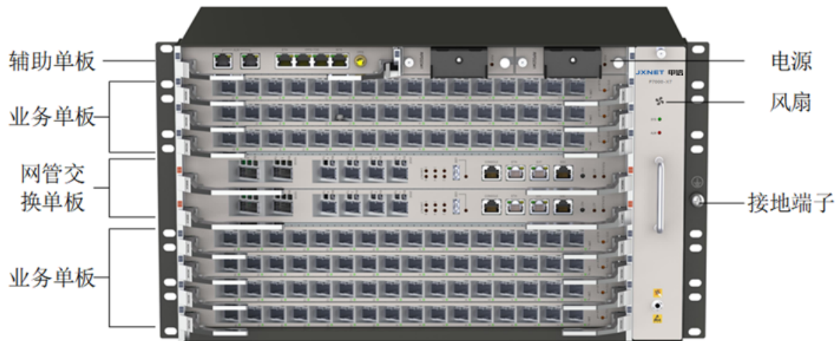
图 2-1 P7000-X7 的机 箱结构示意图
